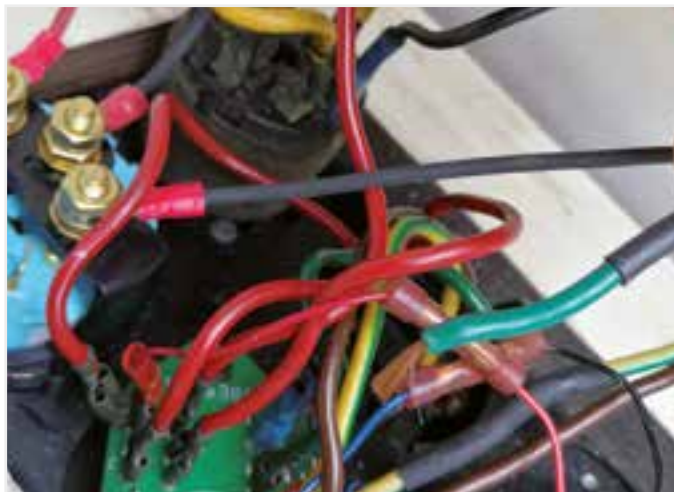
Das grüne Kabel, das sich von dem Kabelschuh getrennt hat, kann zu einem zunächst unbemerkten Fehler mit fatalem Ausgang führen - grün und grün-gelb dienen auf Yachten amerikanischen Ursprungs in der Regel der Erdung und dem Potentialausgleich.
